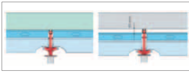
Sistema di banchinatura e cassetteratura modulare con testa a sgancio rapido. Si nota come il sistema consente di recuperare i pannelli mantenendo l'azione di sostegno dei puntelli
